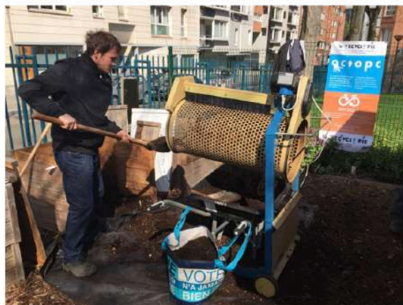
Le compost produit est tamisé. La machine marche à l'énergie solaire. @ Radio France - Marion Chantreau
